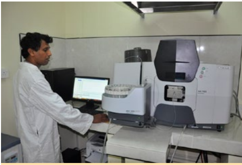
පරමාණු අවශෝෂක වර්ණාවලිමාණය භාවිතා කර පොල් පත්‍රවල පොටෑසියම් හා මැග්නීසියම් ප්‍රමාණය මැනීම
